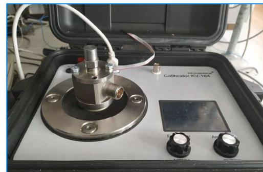
Калибратор KV-184. 1 - электромагнитный вибратор; 2 - разъем питания (24 В); 3 - тумблер включения; 4 - разъем передачи данных (USB); 5 - разъем подключения поверяемого вибропреобразователя (VPE-079) (опционально); 6 - дисплей; 7 - энкодер настройки частоты (Frequency) и выбор (Select) рабочего окна, 8 - энкодер настройки амплитуды (Amplitude) и Start-Stop.
