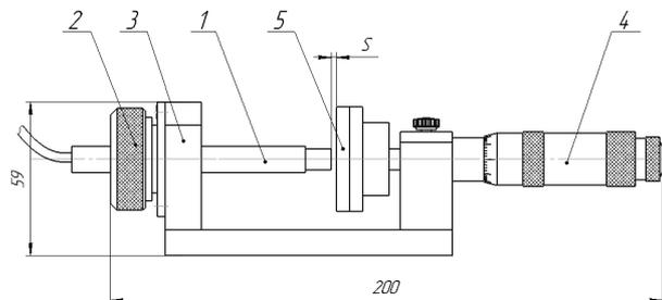
Внешний вид станда ILP-160. 1 – поверяемый преобразователь перемещения вихретоковый; 2 – цанговый зажим; 3 – стойка; 4 – отсчетное устройство типа микрометр МК 25-50 мм; 5 – эталон металла марки 20X13.
